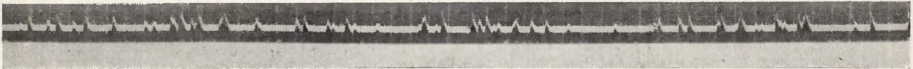
Fig. 3. Photographische registrering van Alphadeeltjes, in onregelmatige intervallen uitgezonden door een radiumpreparaat, naar Th. Wulf.
