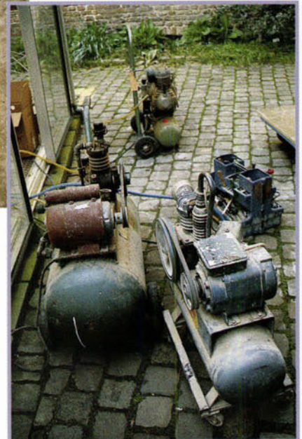
FIGUUR 4 Met drie gekoppelde compressoren raakt het gritstraalpistool niet buiten adem.
