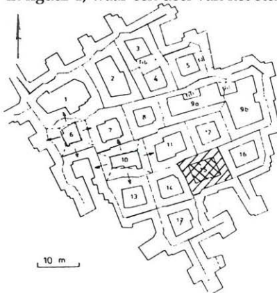
Figuur 1: Plattegrond van een deel van de Geulhemmergrot met de invloedsgebieden aangegeven rond elke pijler (kaart: Technische Universiteit Delft).
